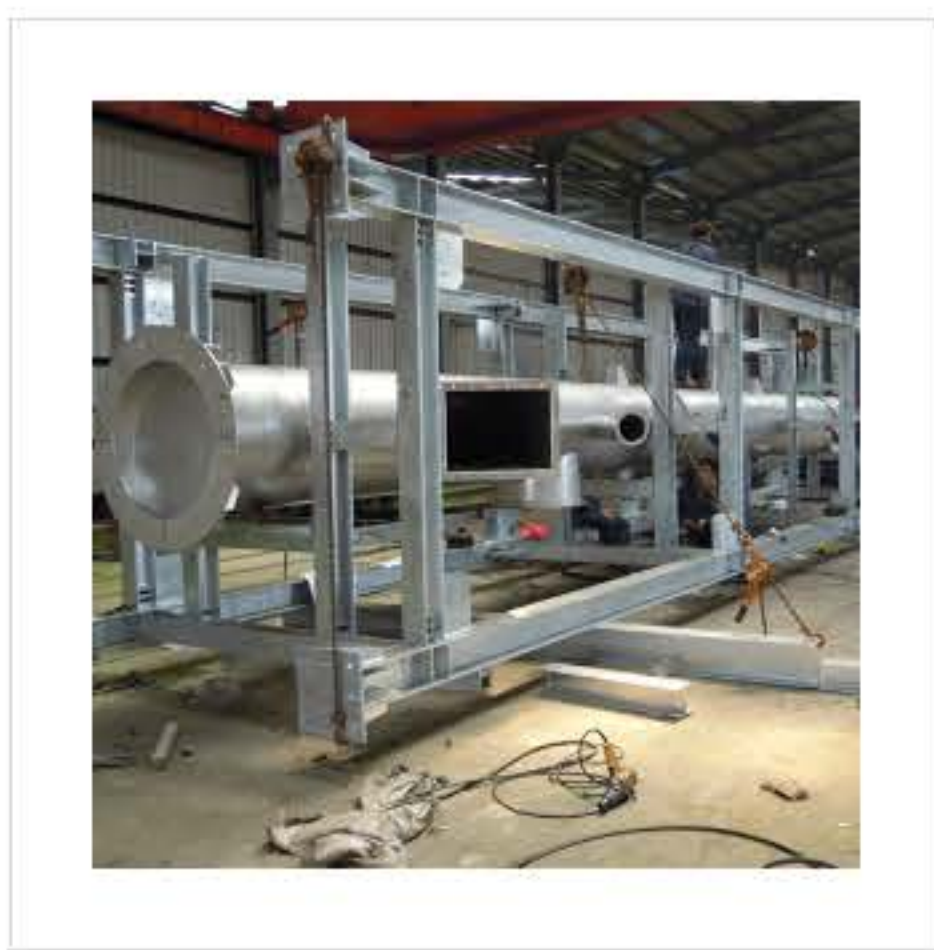
台積煙囪架台工程
